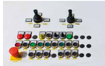
Elektronisches Steuerungssystem für die manuelle Bedienung des Pressarms, ausgelegt für 230/400 V, 50 Hz.
