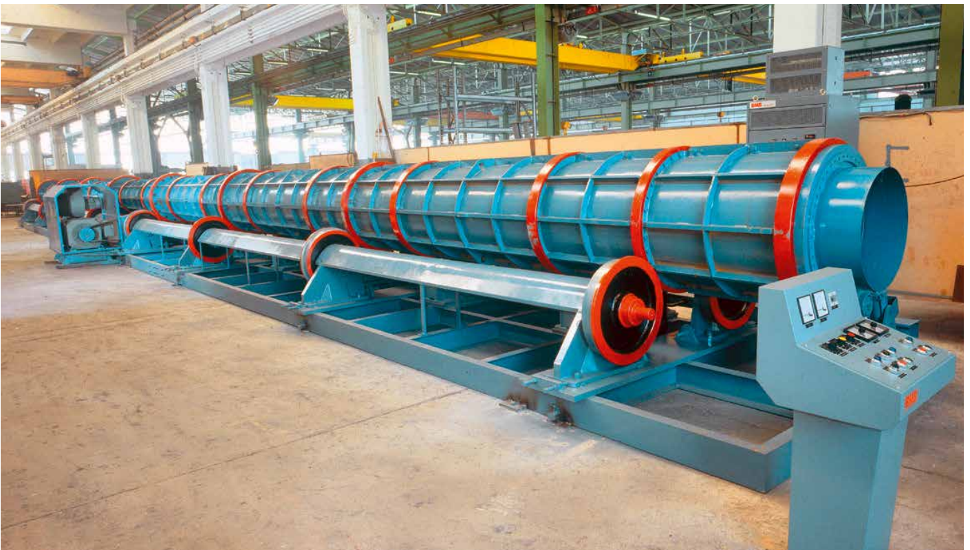
Form für Betonpfähle auf der Schleudermaschine Spun Pile Mould on the Spinning Machine
