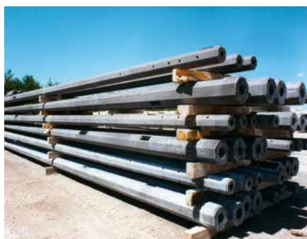
Lagerung von Strommasten Electrical Pole Storage Area
