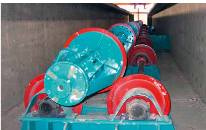
Form für Schleuderbetonmasten auf der Schleudermaschine Spun Pole Mould on the Spinning Machine
