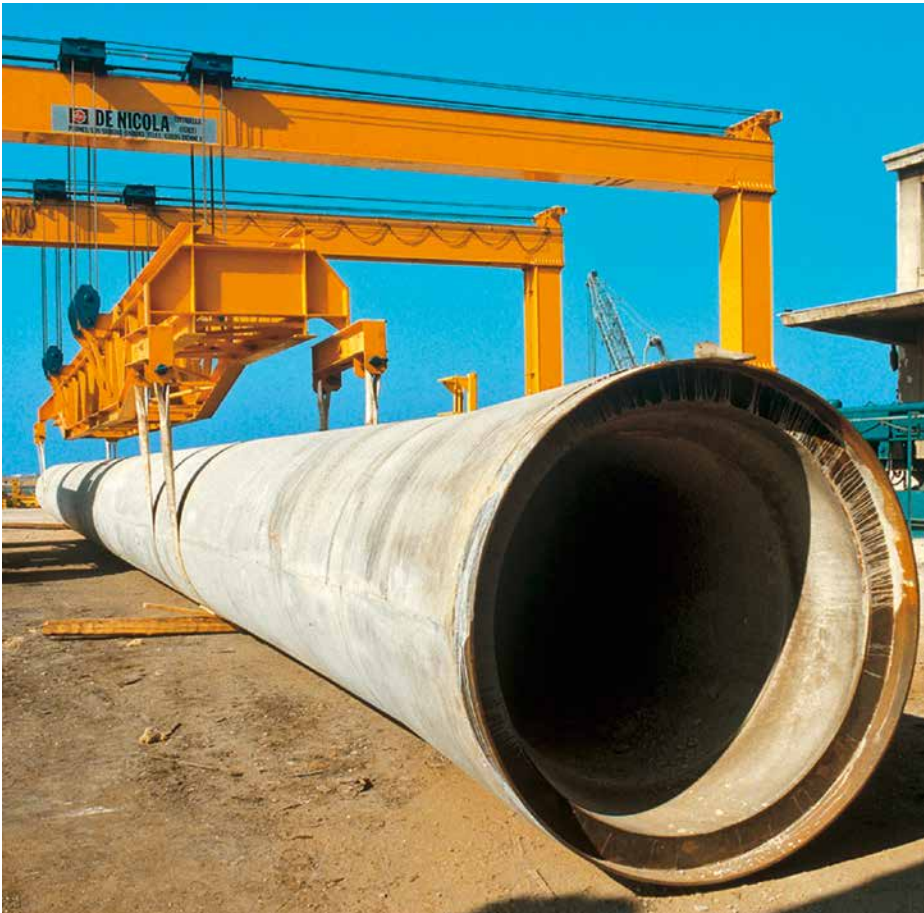
40 Meter langer Betonpfahl 40 Meter long Concrete Pile
