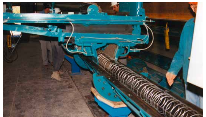
Betonbefüllung Concrete Feeding Process
