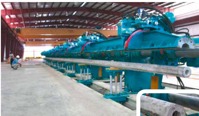
Entschalungsprozess der Schleuderbetonmasten Spun Pole Demoulding Process
