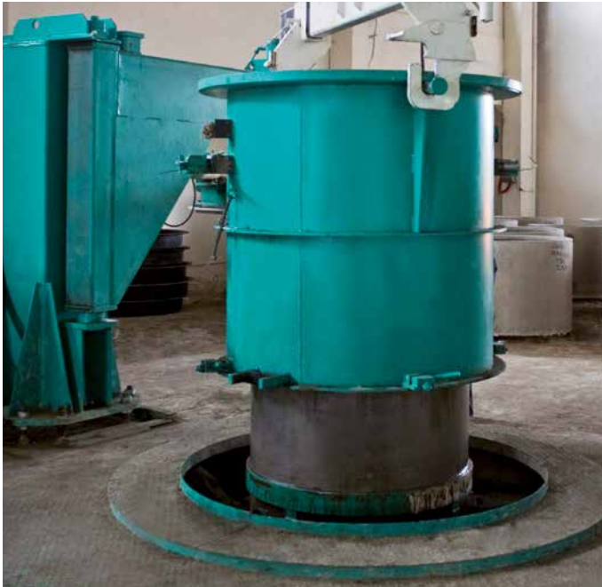
Formeneinrichtung: Formkern und Formmantel mit Zubehör sowie eine für die Handhabung nützliche Traverse. Vibrationssystem mit in den Formkern eingebauten Zentralvibratoren, optional mit Frequenzumformer.
